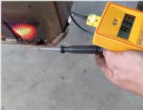
Brûleur latéral Température mesurée supérieure à 800°C
