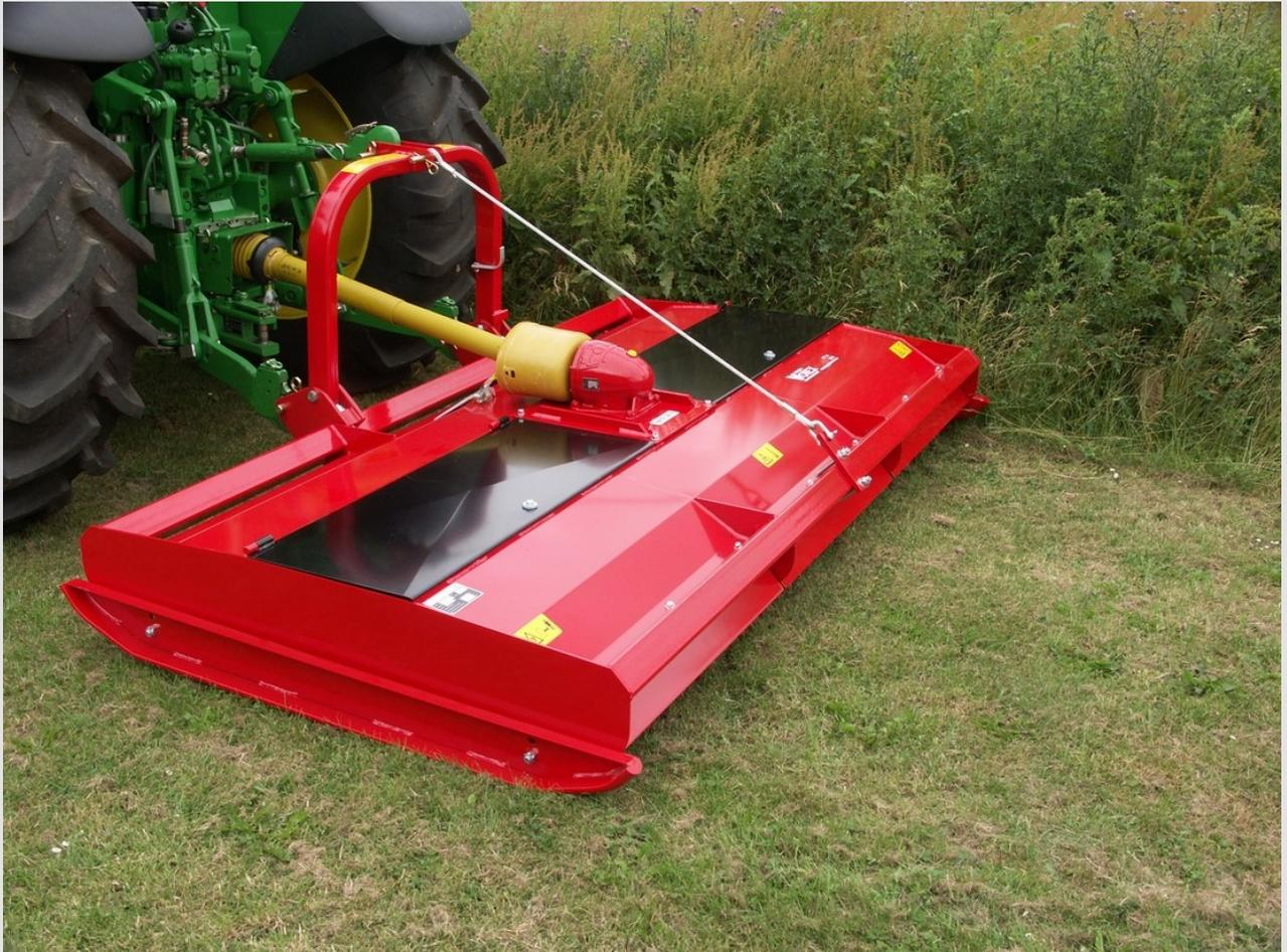
Le châssis a été rendu particulièrement rigide en utilisant une construction de type caisson sur les côtés avant et arrière. De longs patins sur le côté et des guides d'herbe entre les lames en combinaison avec une face inférieure lisse empêchent le basculement et le scalpage, ce qui permet une grande capacité et des vitesses de travail accrues.
