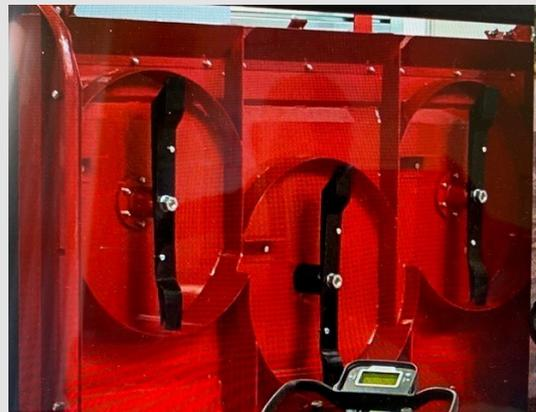
L'option SuperCut, disponible pour les versions SuperBingo 2/170 à 3/300 comprend un kit mulching composé d'une jupe circulaire autour des lames et les lames Duplo.
