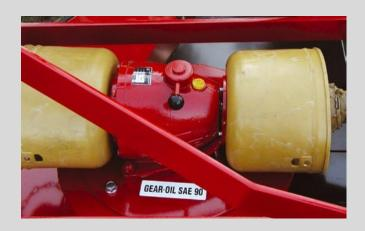
La machine est particulièrement adaptée pour être utilisée en combinaison avec un pulvérisateur de verger. La boîte de vitesses débrayable permet de pulvériser sans tondre. Elle peut également être utilisée pour arrêter la tondeuse lors du remplissage du pulvérisateur.
