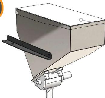
Le MICROLINE est un doseur volumétrique pour la distribution localisée des produits micro-granulaires. La distribution se fait par un rouleau à cellules flexibles, tandis que le réglage est commandé par un écrou rotatif. MICROLINE est facilement adaptable à n'importe quelle machine agricole et peut être livré avec entraînement électrique.
