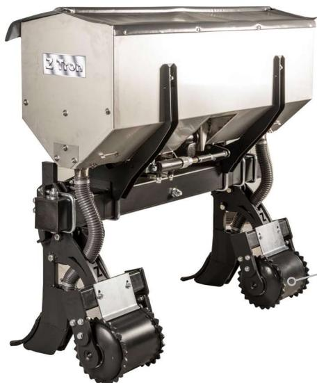
Il s'agit d'un épandeur d'engrais qui permet d'intégrer le produit dans le sol entre les rangs de vignes ou de vergers. FERTIVITIS est équipé d'un châssis fixe avec une trémie en acier Inoxydable, les enfouisseurs à soc, sont équipés de rouleaux dentés est disponible en version 1 ou 2 rangs. L'écartement entre les enfouisseurs des modèles à 2 rangs est de 1,4 ou 2,00 m.
