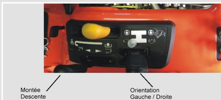
Commandes de relevage et orientation
