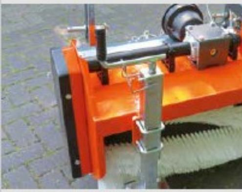
Réglage en hauteur par manivelle et en continu de la balayeuse
