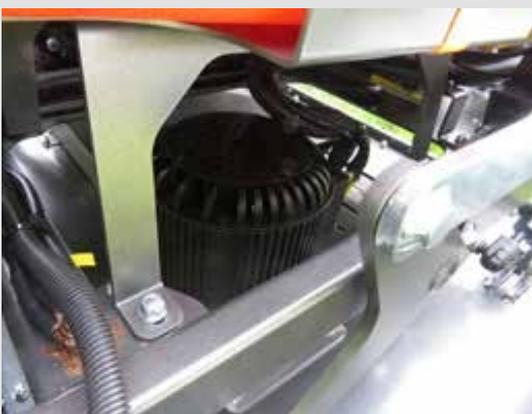
Entrainement électrique du plateau de tonte avec gestion électronique de la charge
