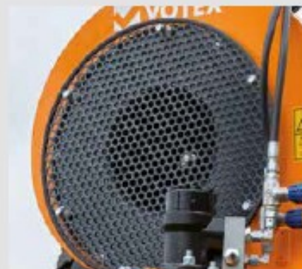
Entrée d'air protégée
