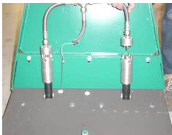
Venturis et buses de pulvérisation interchangeables
