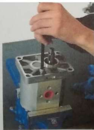
9 - Monter le couvercle, serrer les vis en croix, pas à pas
