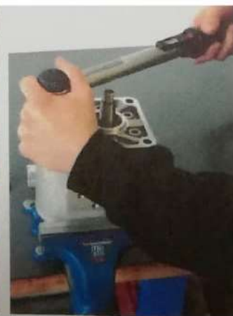
10 - Remettre les vis et bloquer
