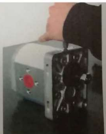
11- Noter le nouveau sens de rotation S = Gauche D = Droite
