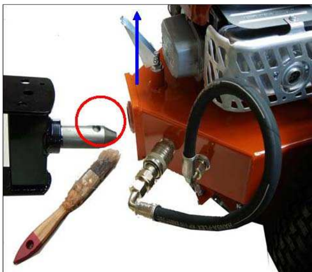
Photo 1 Mise en place de la balayeuse
