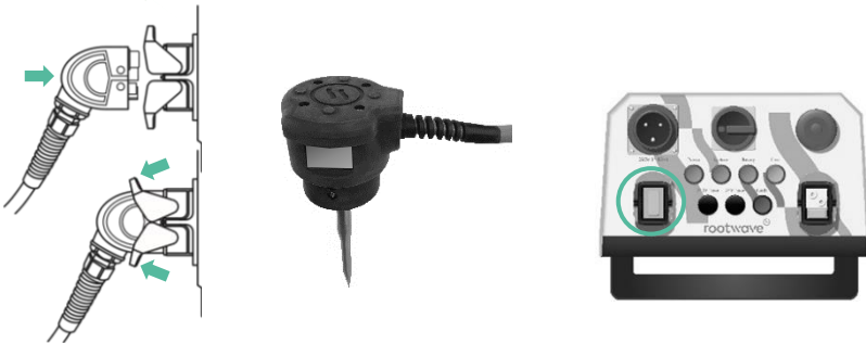
Figure 13 Connectez la masse de sécurité au module d'alimentation
